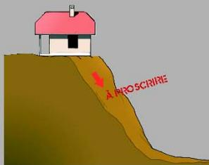
Un glissement de terrain peut emporter toute construction, même parasismique. Des séismes peuvent provoquer des effondrements de falaise: observer une distance de 15 à 20m du bord de la falaise.
