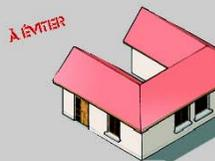
Le plan doit être simple. Il convient d'éviter les formes en T, L, U.
