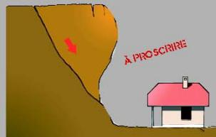
Des éboulements causés par un séisme peuvent entraîner des dommages graves aux constructions: éviter l'implantation au pied d'une falaise ou d'un versant.
